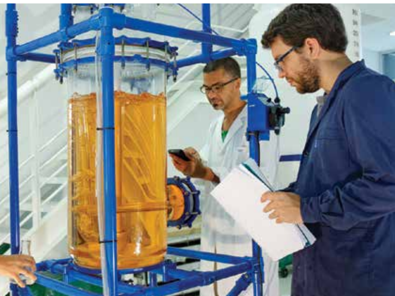
Investigadores del 3iA y la ECyT junto al reactor de la planta piloto en el que las nanoarcillas se mezclarán con una muestra de efluentes contaminados.
